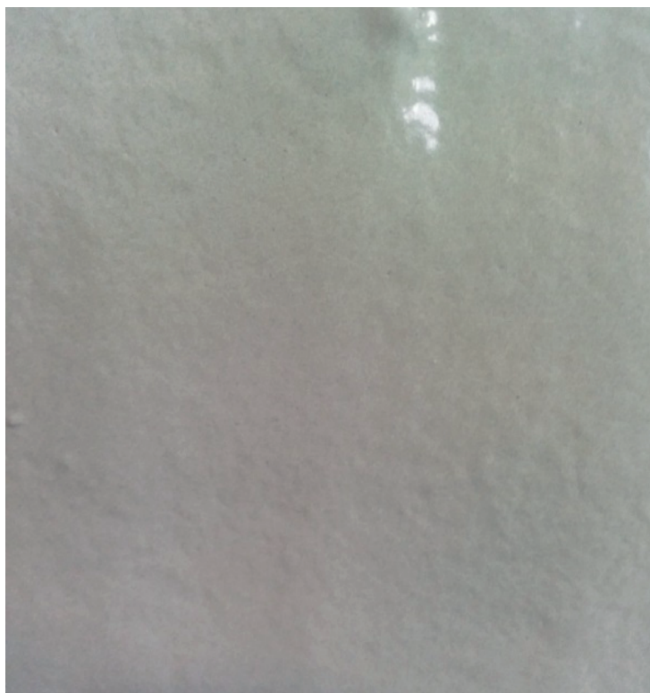
Рисунок В.7 – «Скрепа 2К Эластичная» при безвоздушном распылении
