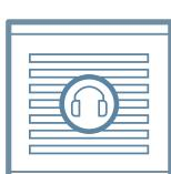
Снижает шум вентилятора, который распространяется по воздуховоду. Состоит из ряда пластин (кулис), установленных по ходу движения воздуха. Когда воздух проходит через кулису, давление передаваемого звука снижается.
