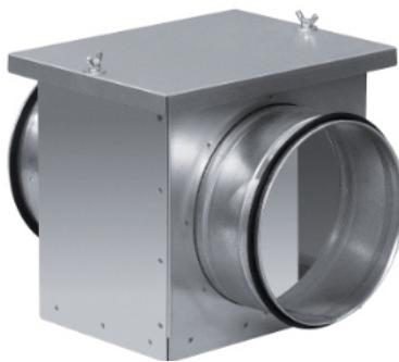
Кассетный фильтр KF предназначен для очистки воздуха в круглых каналах систем вентиляции и кондиционирования промышленных и общественных зданий. Корпус фильтра KF и крышка изготовлены из стального оцинкованного листа. Пластина фильтрующего материала выполнена из синтетического во-
